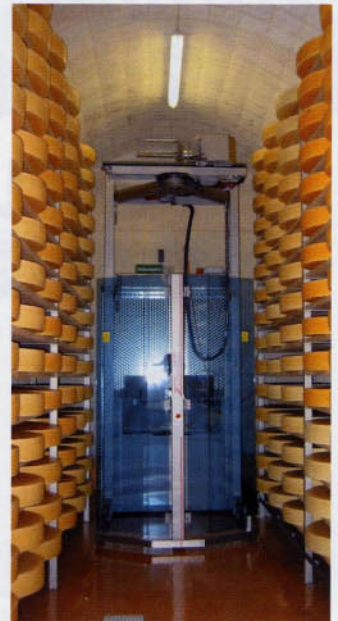
Schmierroboter im Gewölbe
